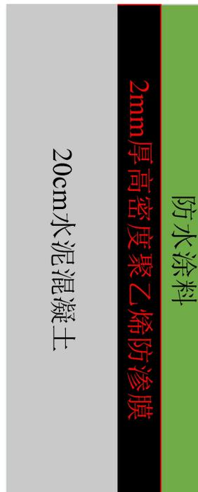
图 4 围堰防渗剖面图
